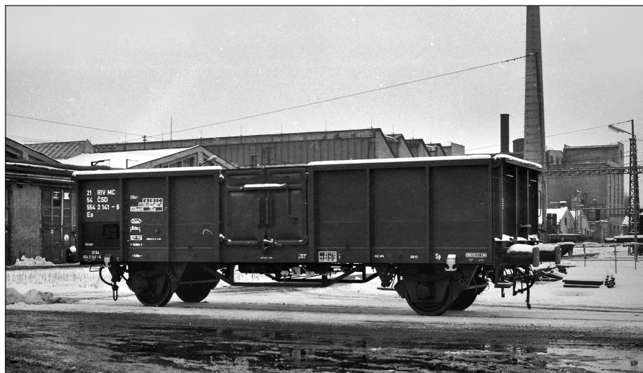
Obr. 12. Dvounápravový nákladní vůz řady Es, který se vyráběl v českolipské vagónce od roku 1979 (fotoarchiv firmy Bombardier Transportation Czech Republic a. s.).
