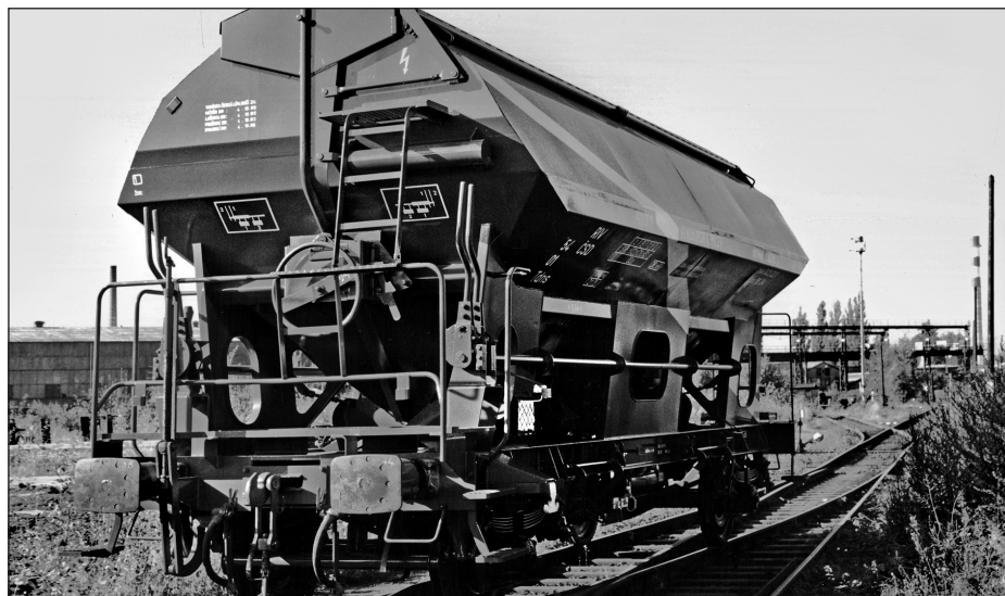
Obr. 15. Dvounápravový nákladní vůz řady Tdns pro přepravu hromadných sypkých substrátů z roku 1992 (fotoarchiv firmy Bombardier Transportation Czech Republic a. s.).
