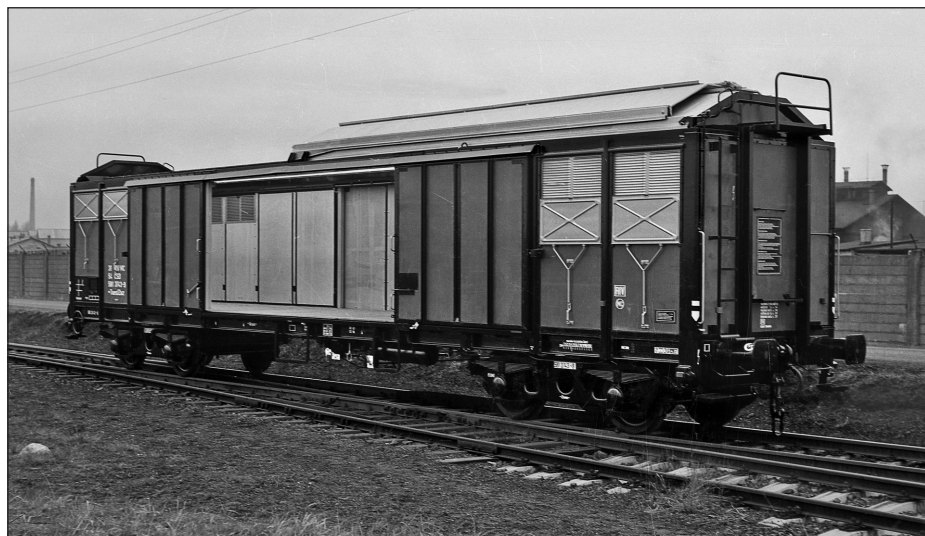
Obr. 11. Čtyřnápravový nákladní krytý vůz s posuvnou střechou řady Taes/Zaz ze 70. let 20. století (fotoarchiv firmy Bombardier Transportation Czech Republic a. s.).
