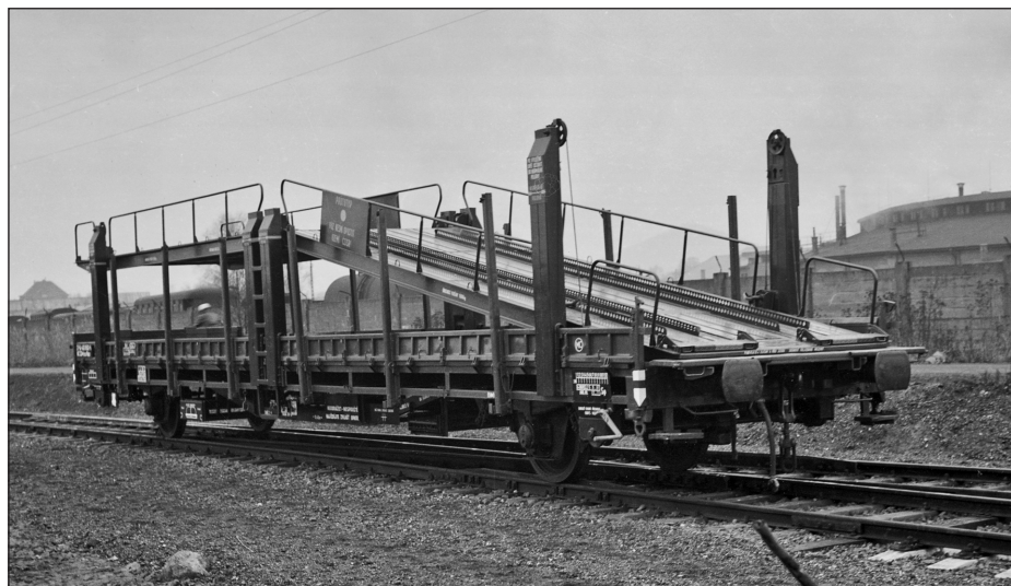
Obr. 13. Dvounápravový patrový vůz, sloužící pro přepravu automobilů (fotoarchiv firmy Bombardier Transportation Czech Republic a. s.).
