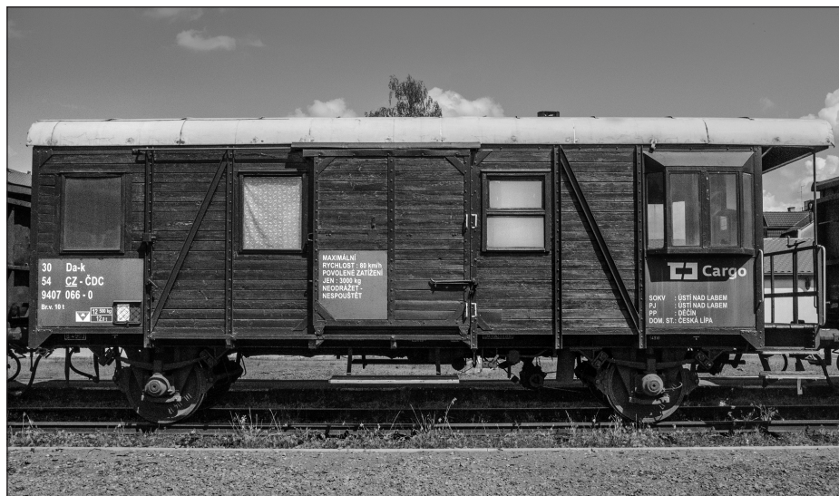
Obr. 9. Služební vůz řady Ds vyrobený v českolipské vagónce, zachycený na českolipském nádraží. V současné době služební vůz používá ČD Cargo (foto Filip Svácha, 2020).
